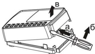
**2)** Отогнуть зацепы на основании, снять печатную плату
