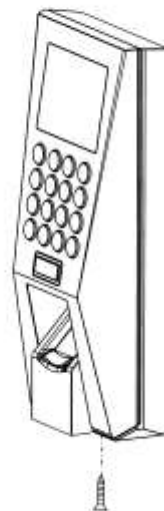
4 Установите контроллер на кронштейн и зафиксируйте его с помощью винта
